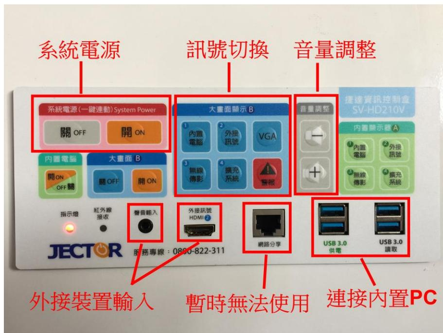
當您按下系統電源，預設是開啟電視及開啟電視內建的 **andriod** 系統，如果您想使用內置 PC，請按訊號切換區的 1，如果您想使用無線投影，請按訊號切換區的 3。音量調整基本上用不到，直接由擴大機的旋鈕控制音量。
