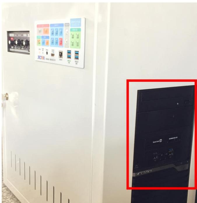
內置 PC 在整合機櫃右側，跟使用一般 PC 一樣，按電源開機，主控面板要切換至輸入源 1。
