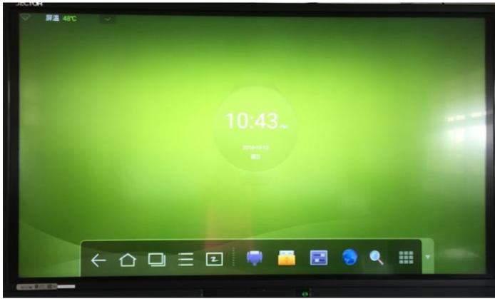
本廠觸控電視支援**多點觸控**，手指頭就可以當滑鼠，你可以把它想像成超大平板。所以不開桌機，它也有內建 **android** 系統及手寫板功能，下面介紹 **android** 系統及手寫板功能。
